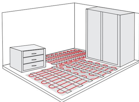
3) Под полученную полезную площадь подберите нагревательный мат, площадь которого примерно равна или меньше площади обогрева. Внимание! Площадь нагревательного мата не может превышать полезную площадь обогрева.
