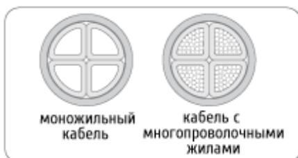
Резка кабеля с цельнотянутыми моножилами требует больших усилий, чем резка кабеля того же сечения с многопроволочными жилами.
