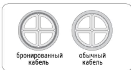
Для резки кабелей с ленточной броней и дополнительной алюминиевой или свинцовой оболочкой потребуется более мощный инструмент, чем тот, который на пределе возможностей разрезает кабель того же сечения без брони и металлической оболочки.
